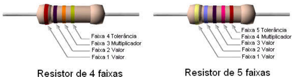
Figura 8 – Significado das faixas em um resistor
