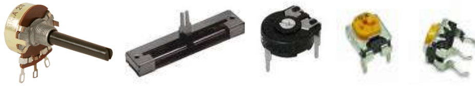
Figura 6 – Potenciômetro Rotativo, Potenciômetro Deslizante e Trim Pots
